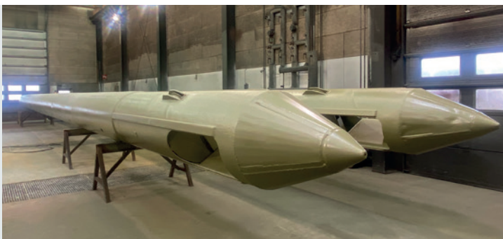
De to støtteben til et Rohde Nielsen fartøj er blevet sandblæst, svejsekontrolleret og overfladebehandlet med 500 My maling.
